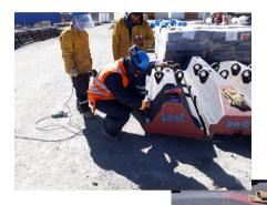
Inspeccionamos liners, parrillas, pernos nuevos de molinos con el objetivo de asegurar la calidad y vida útil de los revestimientos y pernos del Molino SAG. Realizamos controles como contraprueba del dosier de calidad entregado por el
