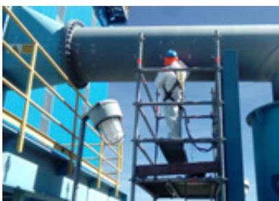
Mediante la técnica de Ultrasonido UT, podemos seguir el desgaste por corrosión de componentes sometidos a fricción, midiendo el espesor y proyectando según la tasa de desgaste del componente. Esta técnica se apoya también en la técnica de Termografía para detectar los puntos con alto diferencial AT e inducir las zonas de mayor desgaste.
