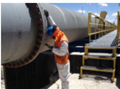
Para el caso de detectar fisuramientos o discontinuidades internas en ejes o componentes sometidos a altos esfuerzos de carga, se usa la técnica de Ultrasonido UT para Detección de Fallas y la avanzada UTPHA de Arreglo de Fases.
