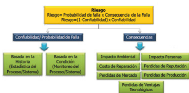
Figura 3. Determinación del Riesgo.
