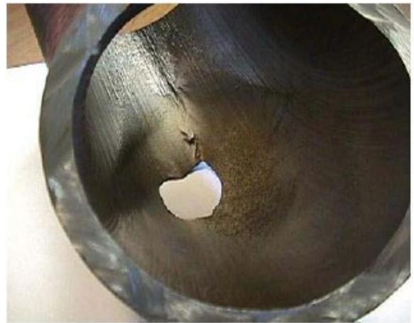
Figura 5. Erosión-Corrosión.
